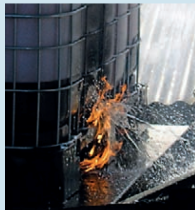
Figuren 11 en 12: HSE test beperkte vuurlast (krantenprop) onder een IBC en het directe gevolg. (Bron: HSE rapport)
