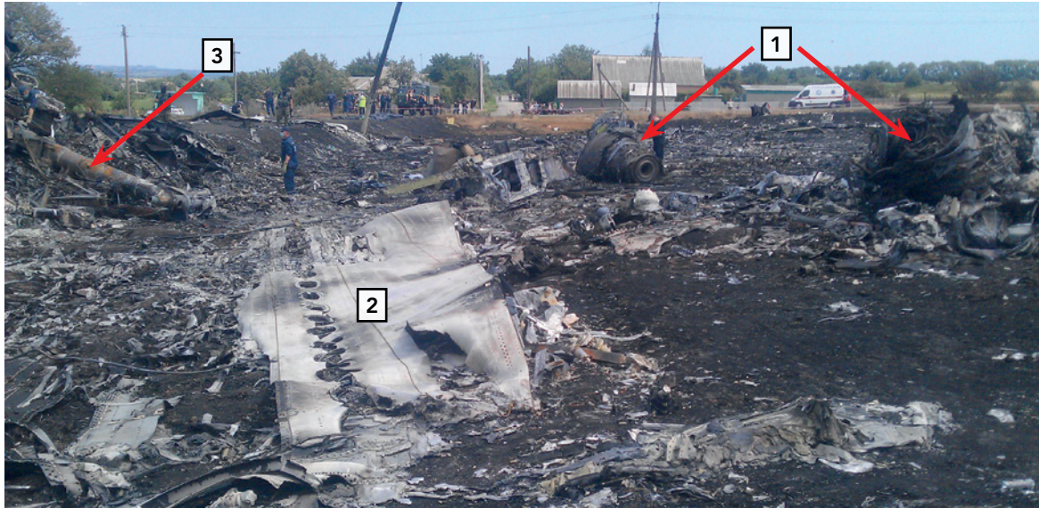
Figuur 11: Hoofdlocatie van het wrak met delen van de motoren (1), vleugel met inspectieluiken (2) en het hoofdlandingsgestel (3). (Bron: NBAAI)
